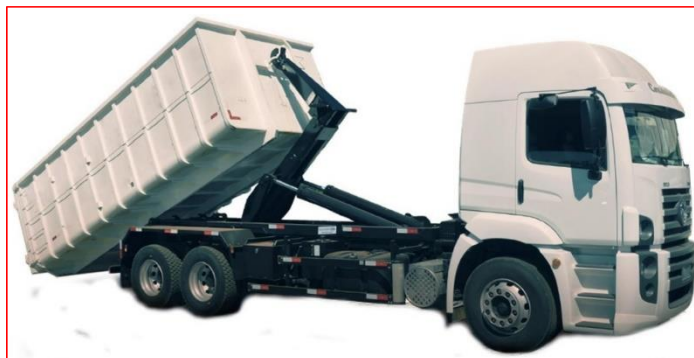
FIGURA 02 – Caminhão Roll On/Roll Off com caçamba
